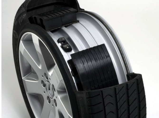
Şəkil 1. Michelin PAX sistemi- avtomobili təkərinin havası boşalsa da sürməyə imkan verir.
